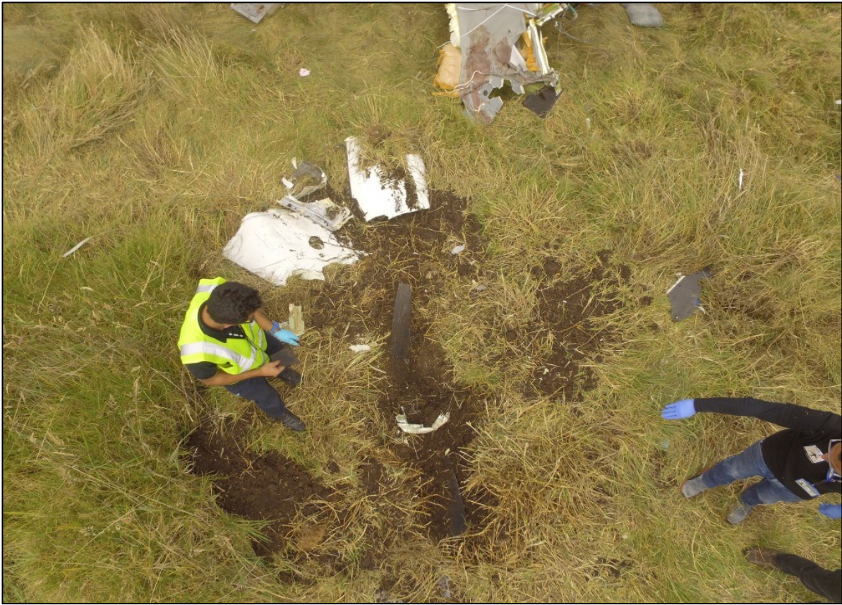
Fotografía No. 6: Punto de impacto de la hélice
