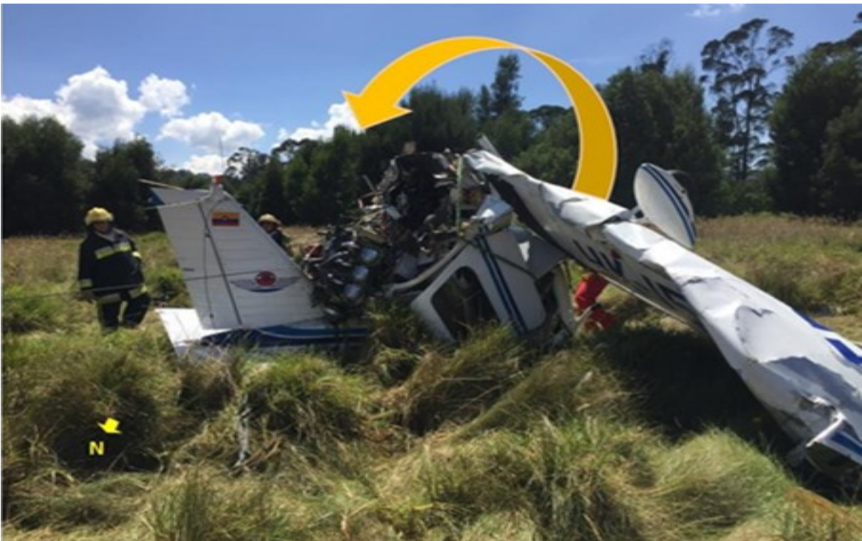
Fotografía No. 5: Efecto escorpión; desprendimiento del motor de su bancada, generando aplastamiento en la cabina de mando.
