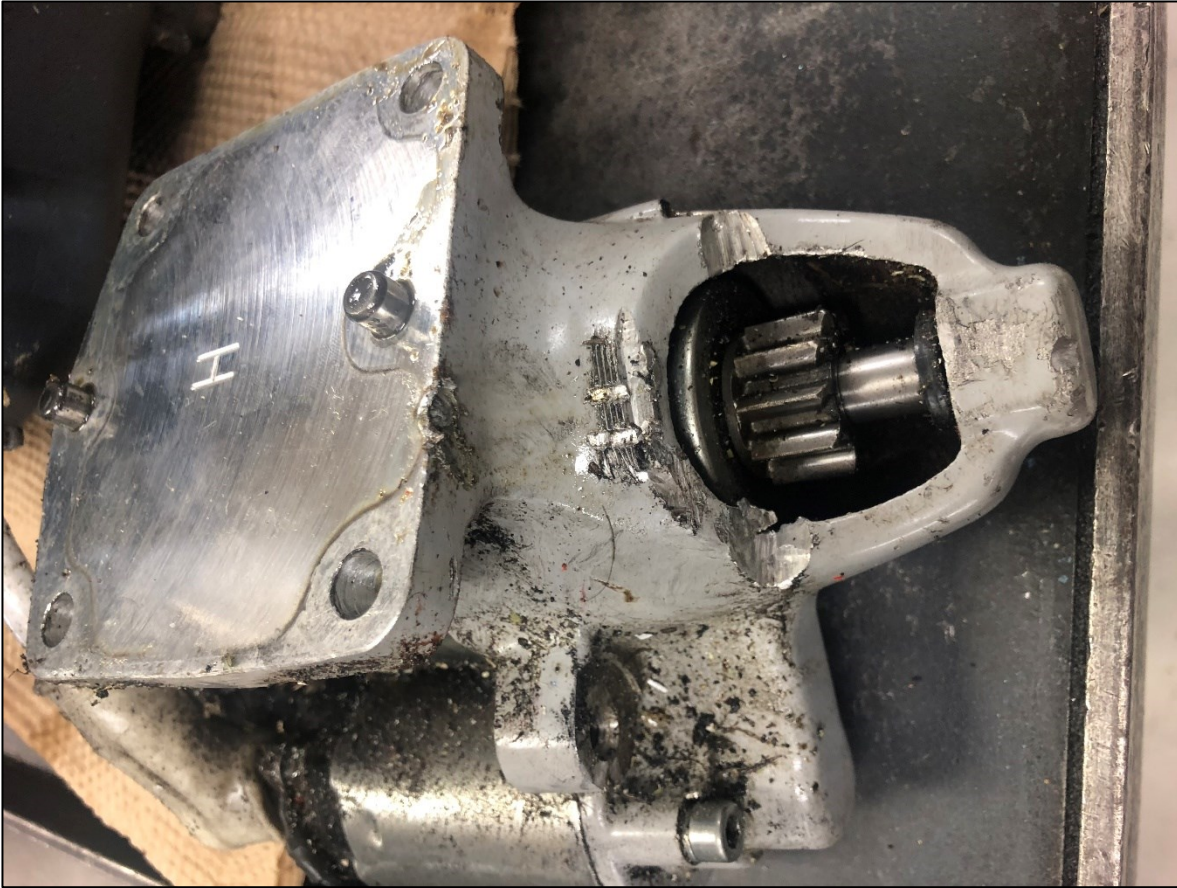
Fotografía No. 10: Piñón de la base de la hélice en donde se observa huella de la rotación “en mínimas” al momento del impacto
