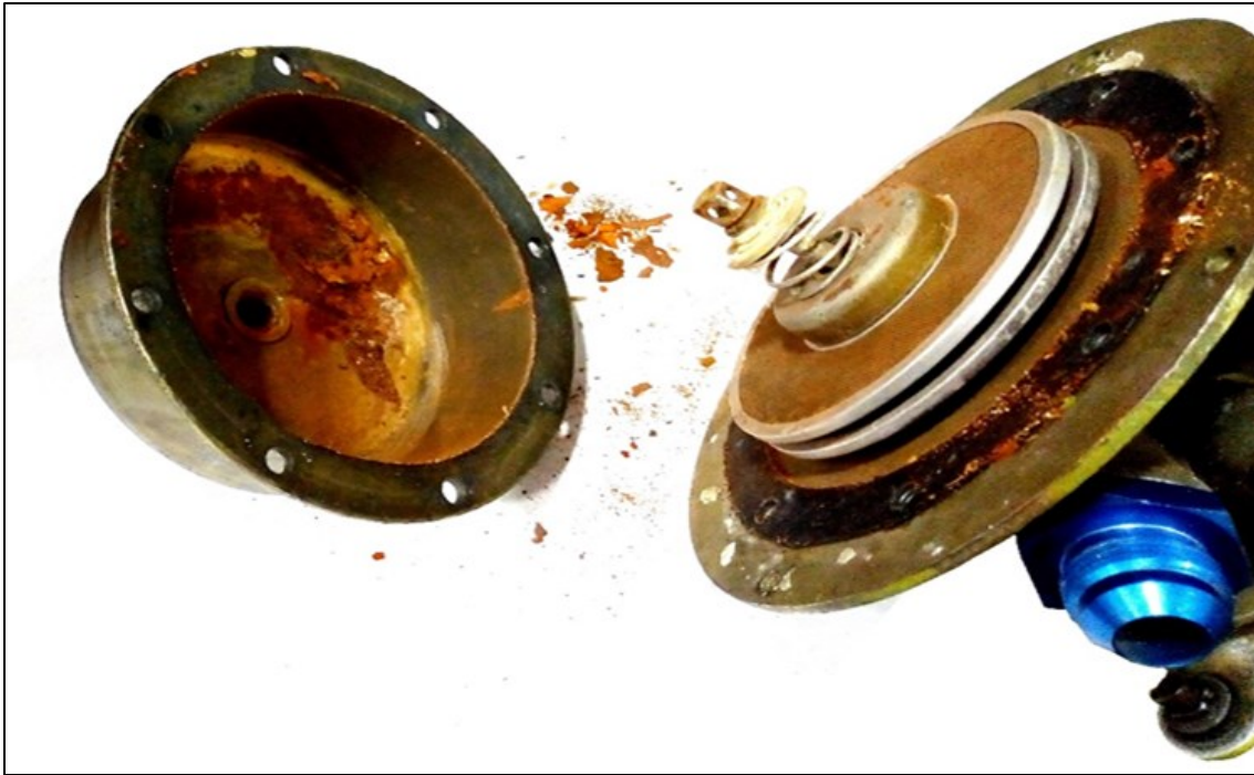
Fotografía No. 12: Oxidación en los filtros de la selectora de combustible
