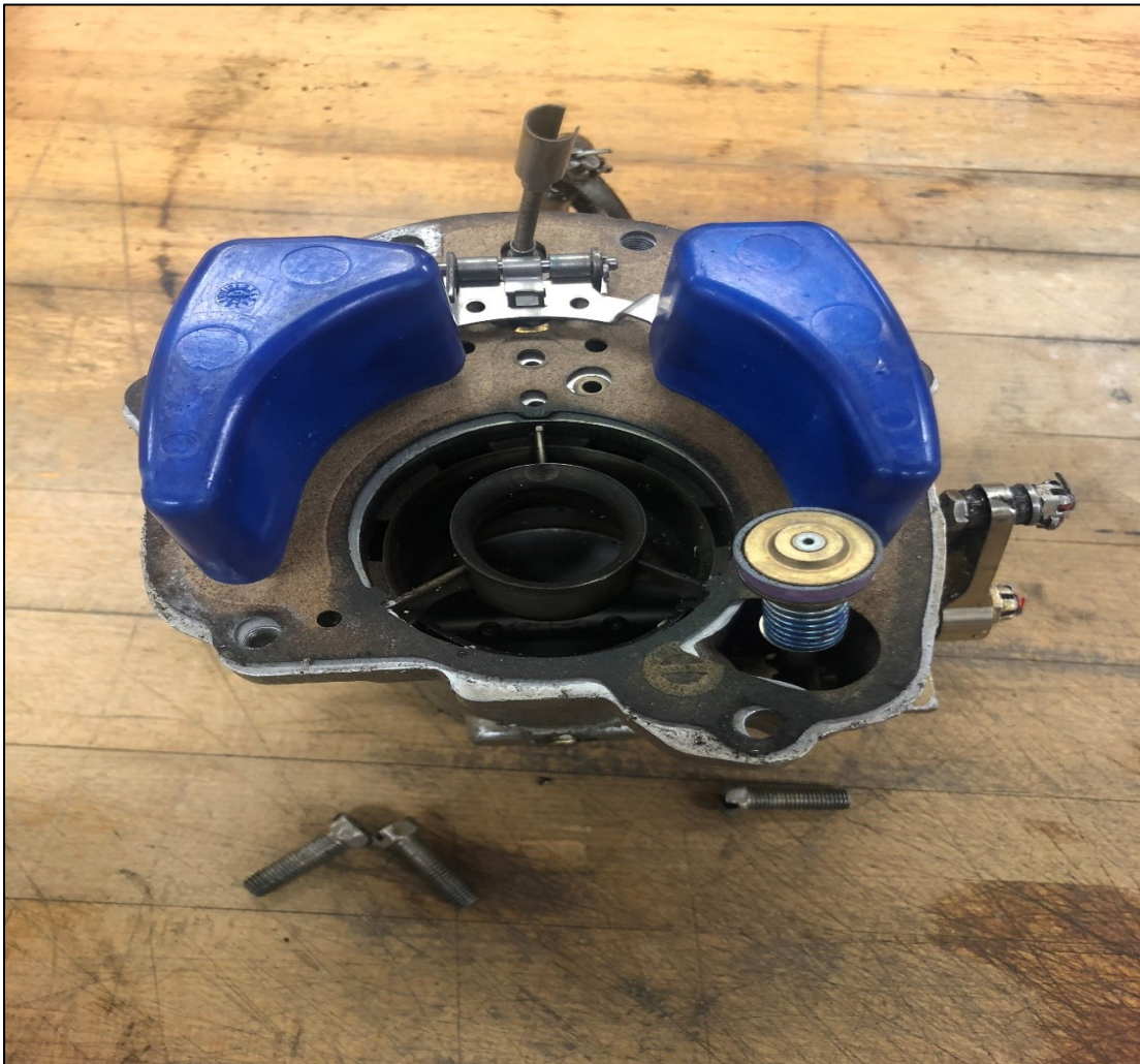
Fotografía No. 9 - Carburador de la aeronave el cual se determinó que funcionaba de manera normal.
