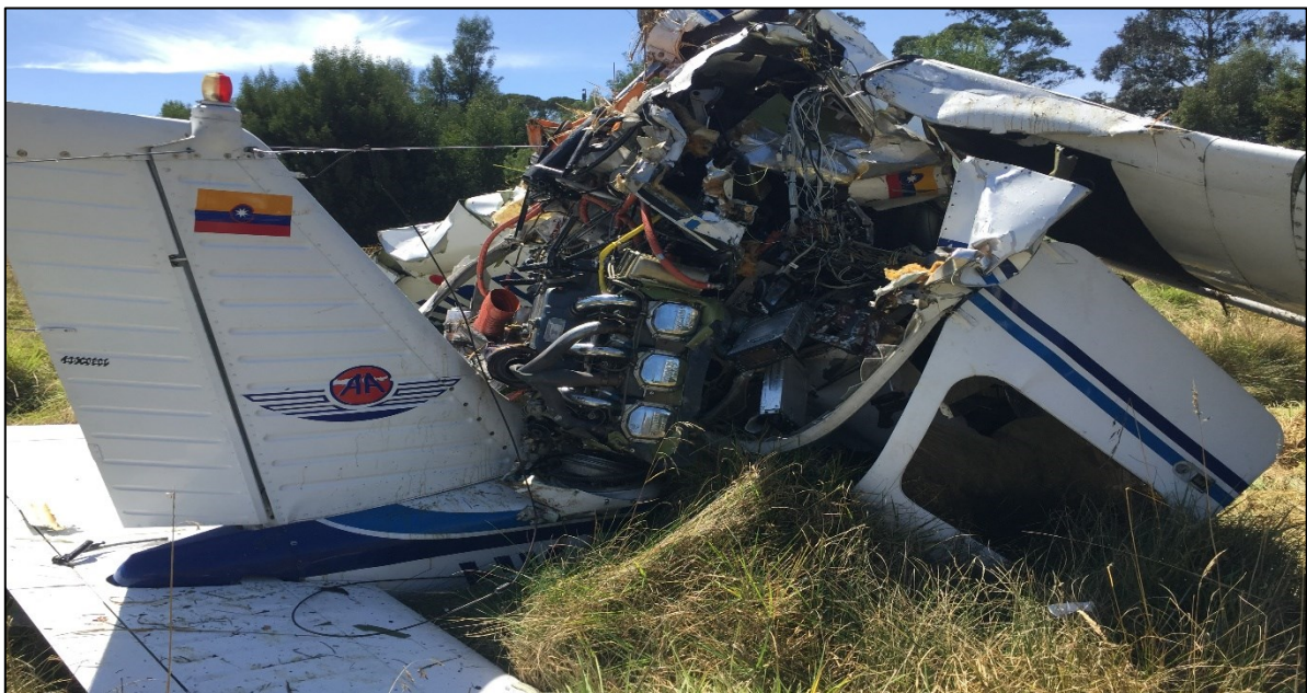
Fotografía No. 7: Posición del motor sobre la cabina posterior al impacto
